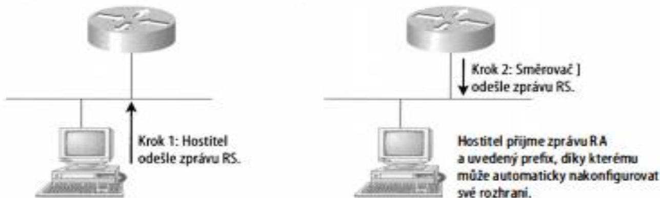
Obrázek 13.2: Dva kroky při automatické konfiguraci protokolu IPv6
