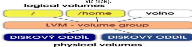
Schéma ilustrující princip funkce LVM
