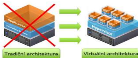
Obrázek č. 1: Srovnání tradiční a virtuální architektury -
